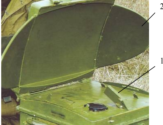
Рис. 3. Антенна система переносної станції наземної розвідки типу ПСРН-5, що складається з опромінювача (1) та дзеркального параболоїда (2)
