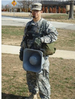
Рис. 1. Ранцева звукомовна станція LRAD-100X
